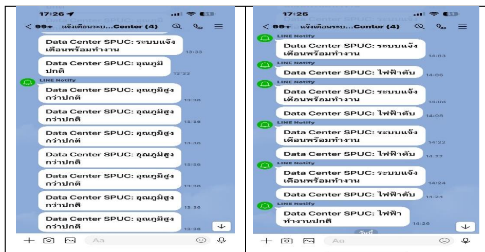
ภาพที่ 6 หน้าจอแสดงการแจ้งเตือนอุณหภูมิ และแจ้งเตือนกระแสไฟฟ้าผ่านแจ้งเตือนไลน์
