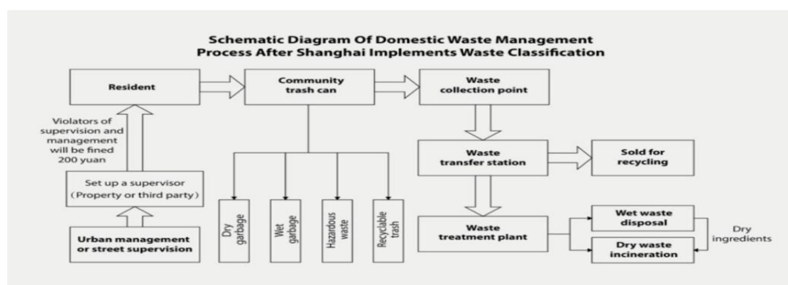
ภาพที่ 1 แนวคิดของกระบวนการจัดการขยะในพื้นที่หลังจากการจำแนกประเภทขยะของนครเซี่ยงไฮ้ ที่มา: Lixiumeng, 2023
