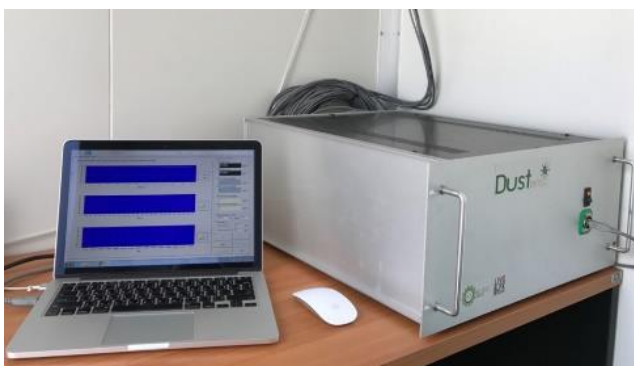
รูปที่ 2 เครื่องมือวัดคุณภาพอากาศแบบเรียลไทม์ (DustDETEC)
