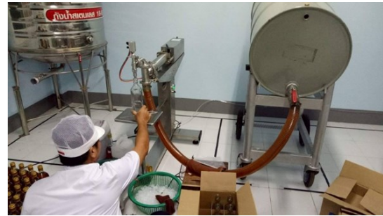
รูปที่ 2 กระบวนการบรรจุน้ำผึ้งแบบเดิม
