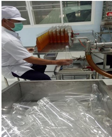
รูปที่ 7 การทดสอบประสิทธิภาพกระบวนการบรรจุ น้ำผึ้ง
