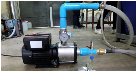
รูปที่ 5 เครื่องผลิตนาโนบับเบิล กำลังการผลิต 10 L/m
