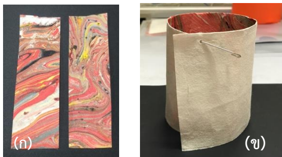
รูปที่ 7 กระดาษสา ขนาด (a) 3 \times 10 cm และ (b) 6 \times 10 cm ก่อนนำเข้าสู่ระบบพลาสมาความดันต่ำ
