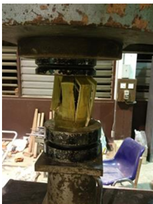
รูปที่ 6 ลักษณะของไม้ไผ่ขณะทดสอบกำลังอัด
