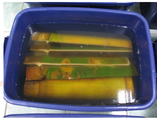
รูปที่ 3 ไม้ใฝ่ที่ทำการเพิ่มความคงทนโดยการแช่น้ำยา Boric Borax
