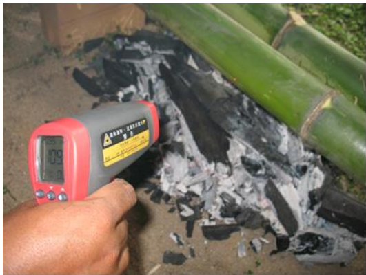
รูปที่ 2 การตรวจวัดอุณหภูมิของไม้ไผ่ขณะย่างไฟ
