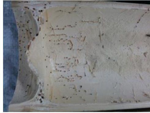
รูปที่ 10 ลักษณะรอยเจาะของแมลงบนเนื้อไม้ไผ่สีสุกที่ไม่ผ่านกระบวนการ
