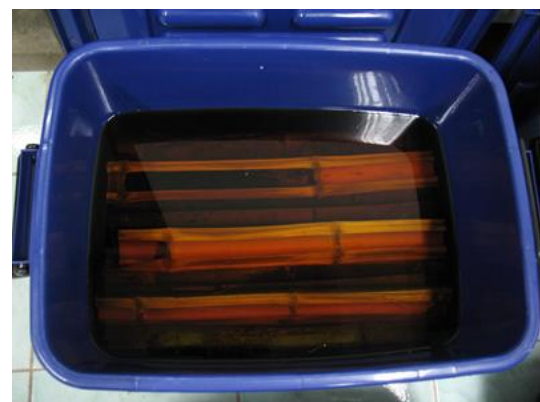
รูปที่ 4 ไม้ใฝ่ที่ทำการเพิ่มความคงทนโดยการแช่น้ำยา CCB
