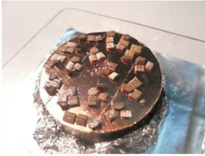
รูปที่ 7 ลักษณะชิ้นงานไม้ไผ่ เพื่อศึกษาสัณฐานวิทยาโดยเครื่อง SEM
