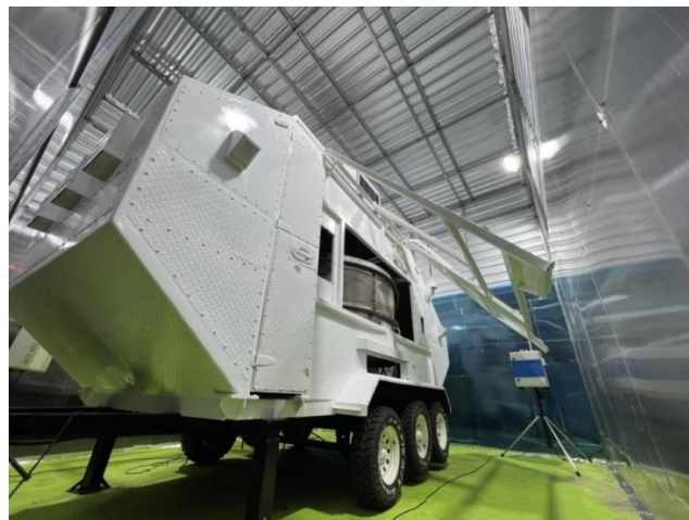
รูปที่ 4 ภาพถ่ายการทดสอบประสิทธิภาพการกรองอนุภาคของเครื่องฟอกอากาศต้นแบบ
