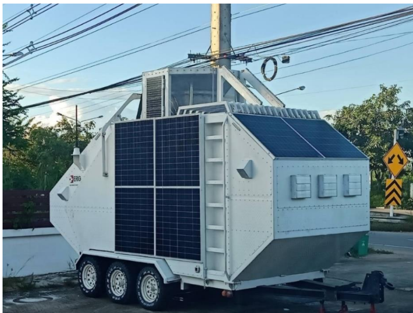
รูปที่ 2 ภาพถ่ายของเครื่องฟอกอากาศระดับชุมชนเมืองที่ใช้เทคนิคการเหวี่ยงหนีศูนย์กลางความเร็วเจ็ทที่พัฒนาขึ้นโดยศูนย์วิจัยและพัฒนานวัตกรรมเพื่อการจัดการภัยพิบัติ
