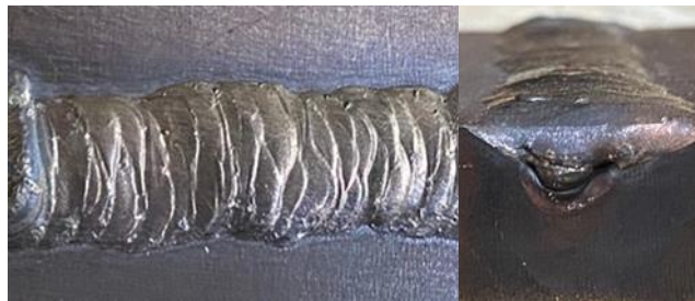
รูปที่ 8 แสดงผลของการของการเพิ่มอัตราการเติมลดเต็ม จากการเติมครั้งละ 1 เส้น เป็นครั้งละ 2 เส้น ทำให้รอยเชื่อมมีความหนาเพิ่มขึ้น วัดจากผิวชิ้นงาน 1.1 มม.
