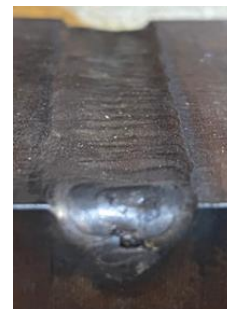
รูปที่ 6 แสดงช่วงกระแสสูงในการทดลอง(111 A) a. พบรอยแตกร้าวที่ผิวรอยเชื่อม 80 % b. ผิวหน้ารอยเชื่อมยุบเว้า -1 มม.
