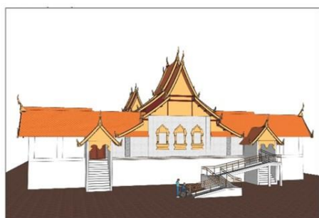
ภาพที่ 15 2) ทางลาดวิหารวัดพระธาตุดอยสุเทพราชวรวิหาร แบบที่ B-1 แบบ 90 องศา 2 ชั้น (ราวจับสแตนเลส)
