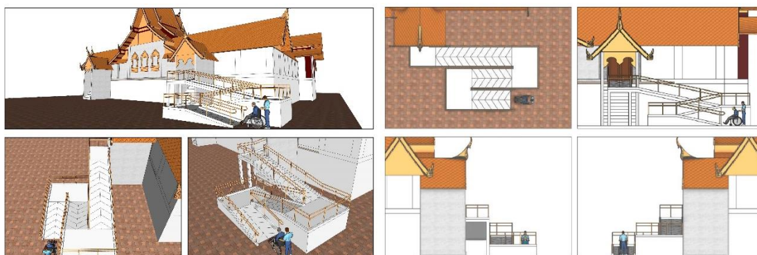
ภาพที่ 36 รูปแบบทางลาดจากข้อเสนอแนะของวัดพระธาตุดอยสุเทพราชวรวิหาร
