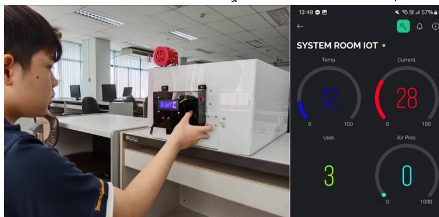
รูปที่ 8 การนับจำนวนผู้ใช้งานจากการสแกนลายนิ้วมือและแสดงผลผ่าน Blynk IoT
