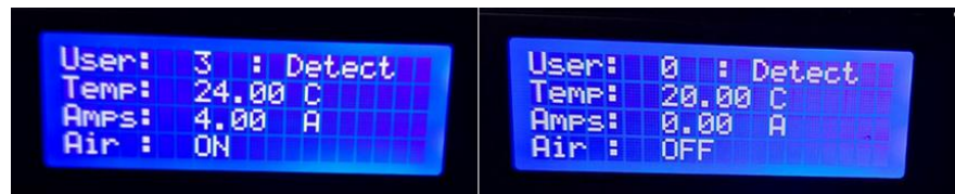
รูปที่ 11 ค่ากระแสไฟฟ้าภายในห้องปฏิบัติการโรงงาน ขณะมีผู้ใช้งานและหลังผู้ใช้งานคนสุดท้ายออกจากห้องปฏิบัติการโรงงาน
