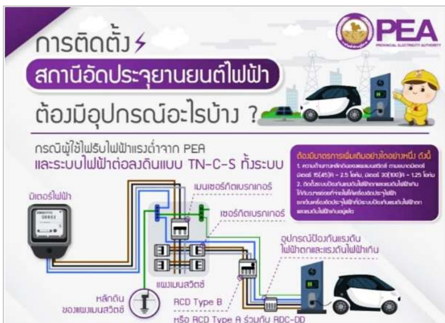
รูปภาพที่ 4 อุปกรณ์และการติดตั้งสถานีอัดประจุรถยนต์ไฟฟ้า
