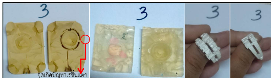
รูปที่ 6 บล็อกแม่พิมพ์ยาง, บล็อกแม่พิมพ์ซิลิโคน, หล่อโลหะ จากแหล่งที่ 3
