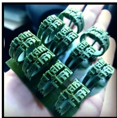
รูปที่ 3 งานพิมพ์ 3 มิติที่ได้จากเครื่องพิมพ์ 3 มิติ เอนวิซเซิน เทคโนโลยี วัสดุเรซินชนิด Wic 100
