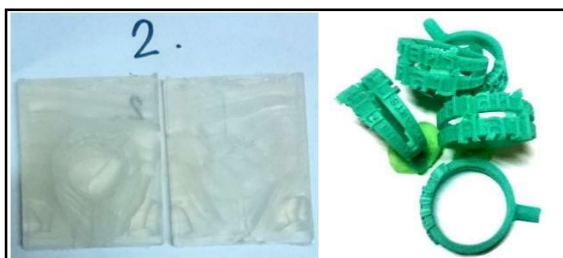
รูปที่ 11 เทียนซีฟิ่งจากการฉีดแบบจากบล็อกซิลิโคน แหล่งที่ 2
