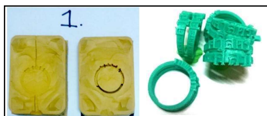
รูปที่ 7 เทียนซีฟิ่งจากการฉีดแบบจากบล็อกแม่พิมพ์ยาง จากแหล่งที่ 1
