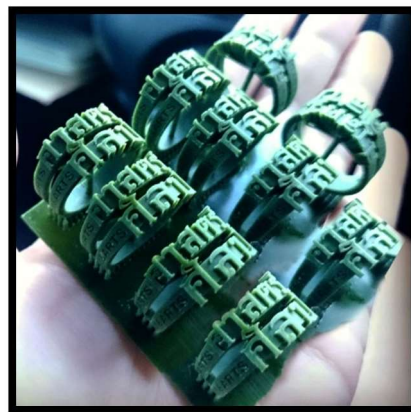
รูปที่ 3 งานพิมพ์ 3 มิติที่ได้จากเครื่องพิมพ์ 3 มิติ เอนวิซเซิน เทค วัสดุเรซินชนิด Wic 100
