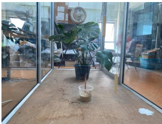
ภาพที่ 1 การติดตั้งอุปกรณ์สำหรับการทดสอบ PM2.5 ในกล่องทดสอบ และต้นพืชระหว่างการทดสอบ
