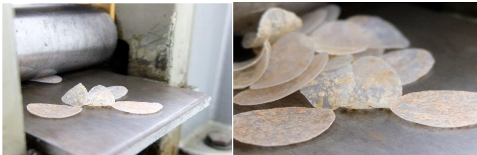
ภาพที่ 7 ผลลัพธ์ด้านวัสดุที่สามารถรีดเป็นแผ่น
