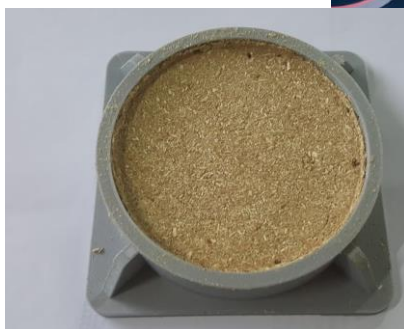
ภาพที่ 2 แม่พิมพ์สำหรับการผลิตชิ้นตัวอย่างเพื่อการทดสอบการดูดซับเสียง
