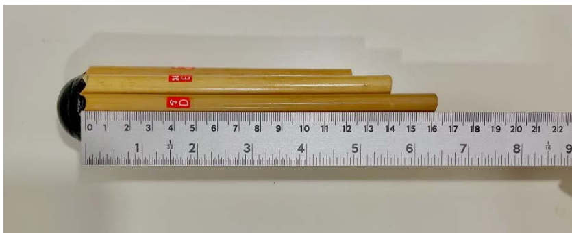
ภาพที่ 7 การวัดความยาวของท่อน้ำพอง (L) ในแต่ละตัวโน้ตของเครื่องดนตรีโหวด
