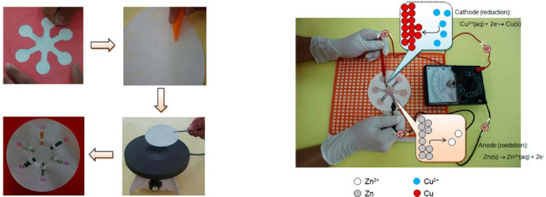
ภาพที่ 4 (ซ้าย) อุปกรณ์สาธิตการทดลองเซลล์กัลวานิกแบบกระดาษอย่างง่าย; (ขวา) การวัดค่าศักย์ไฟฟ้าของคู่เซลล์และการใช้ภาพแทน sub-microscopic representation อธิบายปฏิกิริยาที่เกิดขึ้น (Chatmontree et al., 2015)
