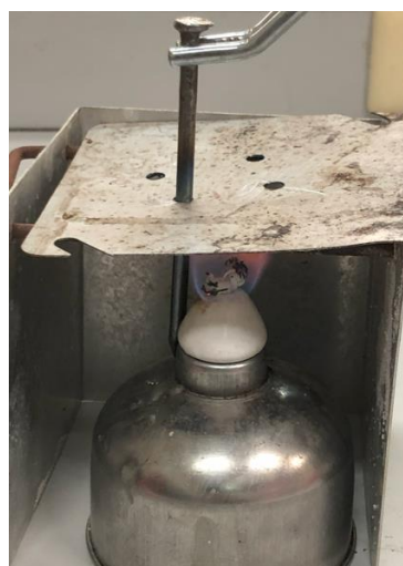
(ข) เมื่อเผาแผ่นโลหะให้ร้อน รูบนแผ่นโลหะขยายตัว ตะปูเข้าได้
