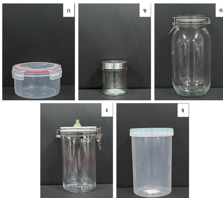
รูปที่ 1 รูปแบบภาชนะต่างๆที่นำมาใช้ในการทดสอบ (ก) พลาสติกโพลิโพรพิลีน (PP) ขนาด 1 ลิตร (ข) ขวดแก้วขนาดเล็ก (ค) ขวดแก้วขนาดใหญ่ (ง) พลาสติกประเภทพอลิสไตรีน (PS) (จ) พลาสติกโพลิโพรพิลีน ขนาด 2.1 ลิตร
