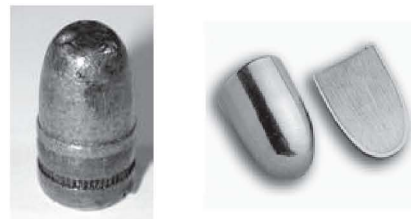
ภาพที่ 1.7 แสดงโครงสร้างองค์ประกอบของลูกกระสุนปืน ชนิดหัวตะกั่ว (Plain Lead Round-nosed Bullet) และชนิด ทองแดงหุ้มตะกั่ว (Copper jacketed full-metal-case Bullet) ( http://www.FirearmsID.com , 21 มีนาคม 2553)
