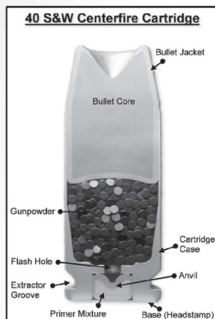
ภาพที่ 1.5 แสดงโครงสร้างองค์ประกอบของกระสุนปืน ( http://www.FirearmsID.com , 13 มีนาคม 2553)
