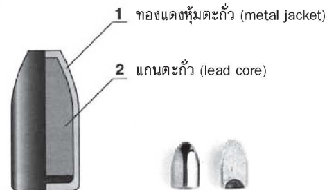
ภาพที่ 1.6 แสดงโครงสร้างองค์ประกอบของลูกกระสุนปืนชนิดทองแดงหุ้มตะกั่ว ( http://www.world.guns.ru , 13 มีนาคม 2553)
