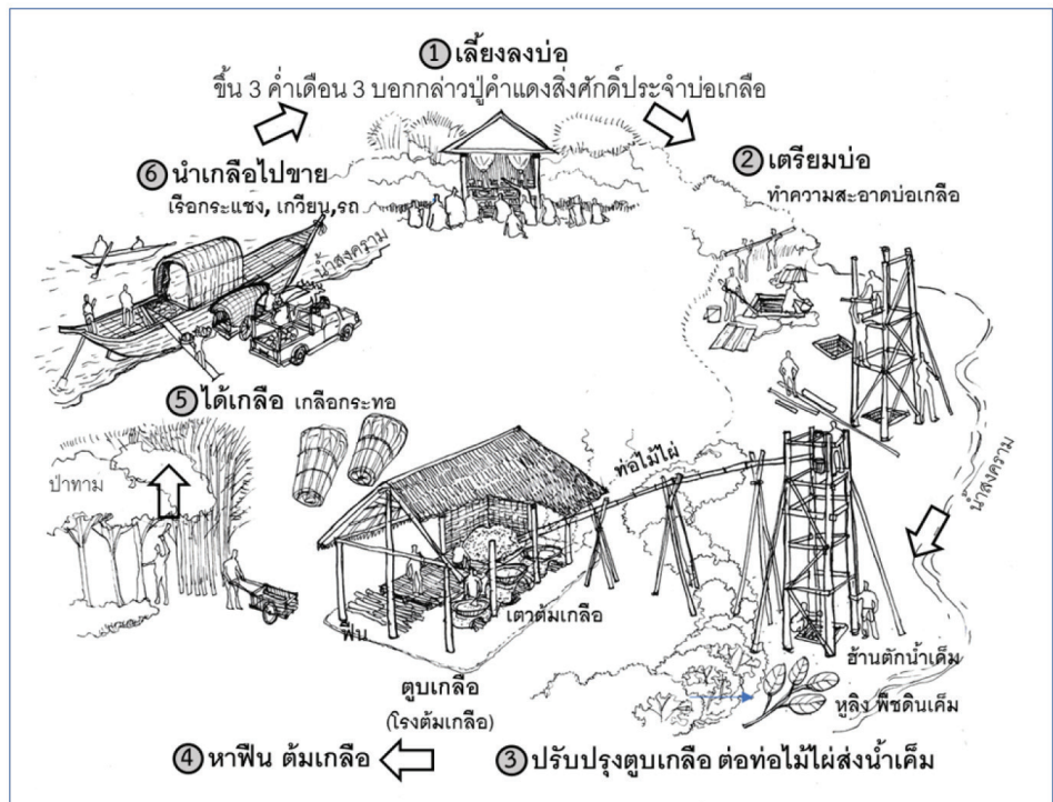
ภาพที่ 4: ลายเส้นแสดง วงจรการทำเกล็ดแบบนำน้ำบาดาลเค็มขึ้นมาต้ม กรณีศึกษา บ่อหัวแฮต อ.เซกา จ.บึงกาฬ
