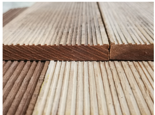
ภาพที่ 15: ไม้แป้นเกล็ดแปรรูปแบบอุตสาหกรรม ผิวหน้าเป็นร่องเพื่อลดการห่อตัวและช่วยในการระบายน้ำฝน
