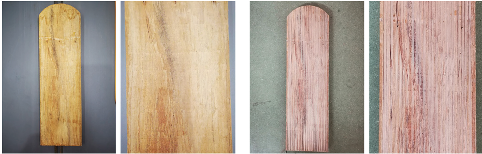
ภาพที่ 16: ซ้าย-ขึ้นตัวอย่างไม้แป้นเกล็ดแบบประยุกต์ก่อนแปรรูป ขวา-ขึ้นตัวอย่างไม้แป้นเกล็ดแบบผสมผสานหลังแปรรูป
