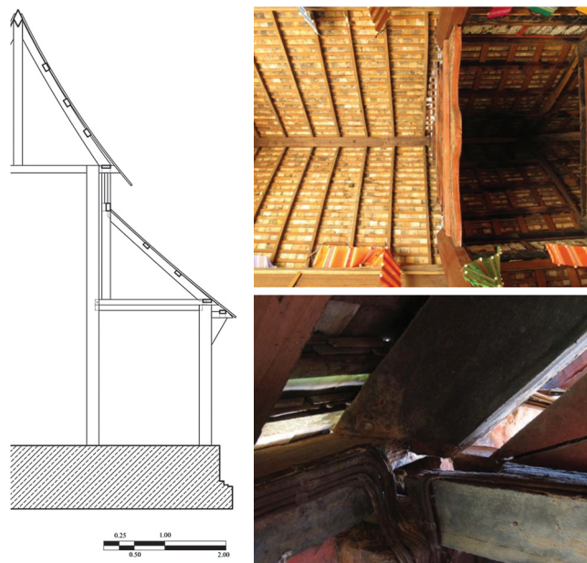
ภาพที่ 7: ภาพซ้าย แสดงแบบสถาปัตยกรรมภาพตัดขวางวิหารวัดกองแขก ภาพขวาบน คือ รอยต่อระหว่างชดเล็กและชดใหญ่ และภาพขวาล่าง คือ รอยต่อที่หัวเสา
