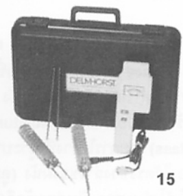
ภาพที่ 12-13 การวัดความชื้นในผนัง EIFS โดยใช้ Moisture Meter
