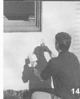
ภาพที่ 12-13 การวัดความชื้นในผนัง EIFS โดยใช้ Moisture Meter
