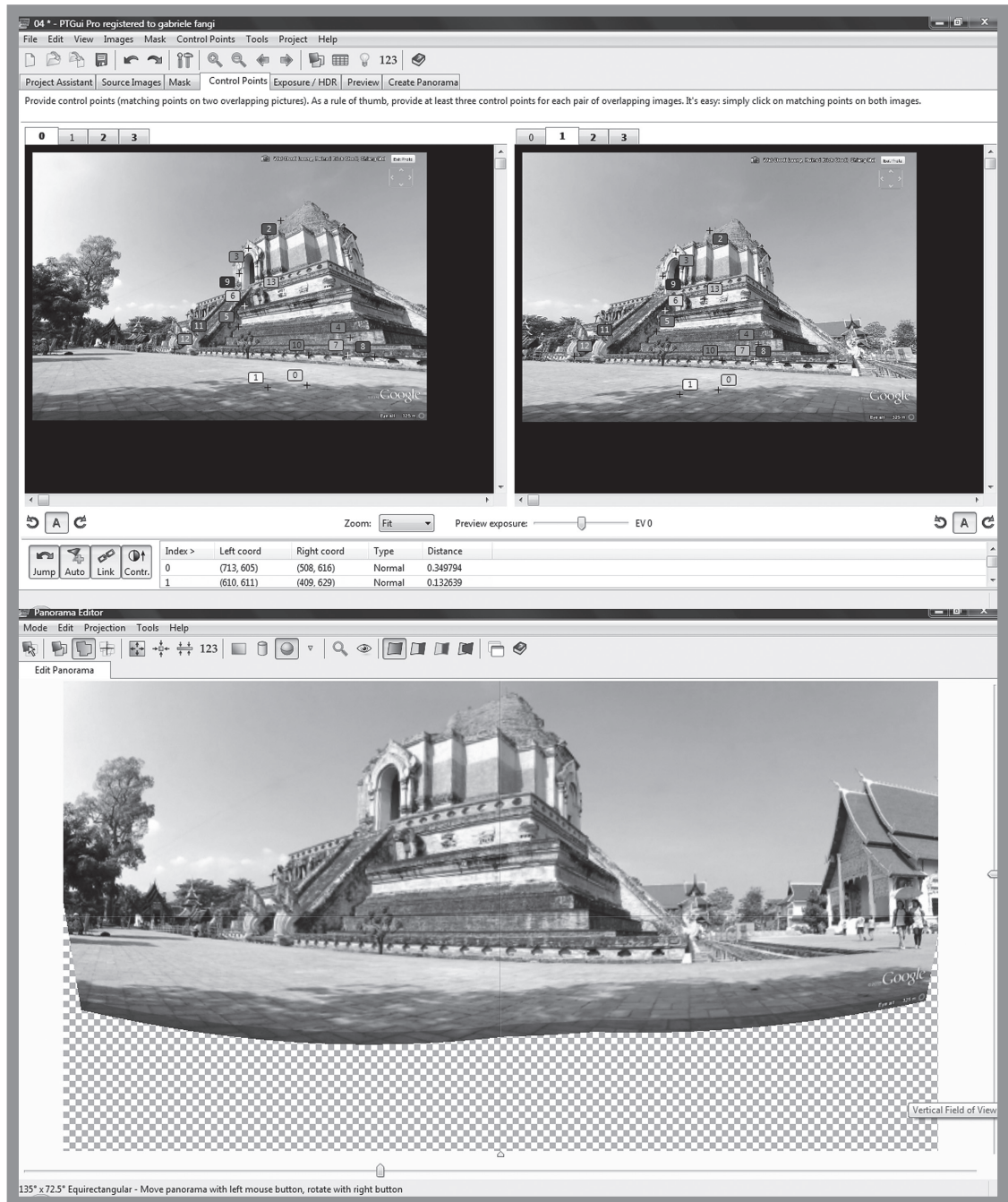
ภาพที่ 4 กระบวนการในการสำรวจรังวัดด้วยภาพดิจิทัล ภาพประกอบแสดงขั้นตอนและกระบวนการแก้ไขค่าบิดเบือนของภาพ และการสร้างภาพมุมกว้าง โดยใช้โปรแกรม PTGui กรณีศึกษา เจดีย์หลวง วัดเจดีย์หลวง จ.เชียงใหม่
