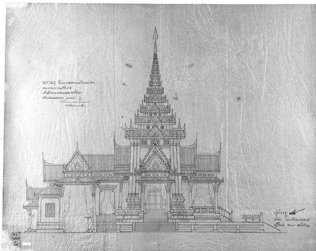
รายการที่ 14 แบบรูปด้าน พระเมรุ สมเด็จพระอนุชาธิราช เจ้าฟ้ากรมหลวงนครราชสีมา มาตราส่วน 1:50
