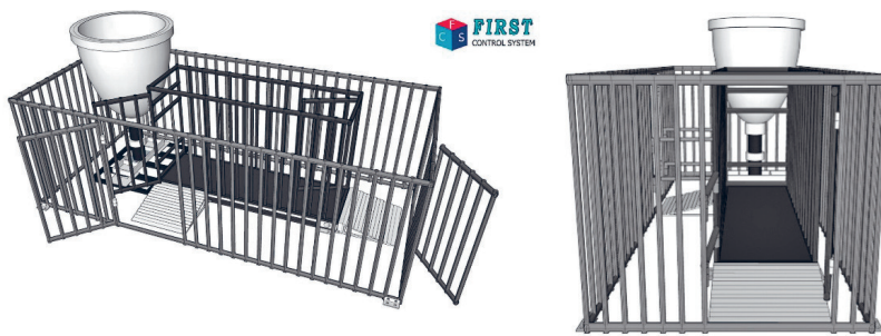
ภาพที่ 5 ระบบกรงเพื่อชั่งน้ำหนักหมูจากภาพ
