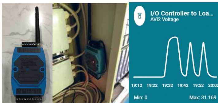
ภาพที่ 13 LoRa I/O และค่าสถานะของแรงดันเพื่อใช้ในการส่งข้อมูลต่างๆ จากเซนเซอร์ภายในเล้าหมูไปยังลอราแวน
