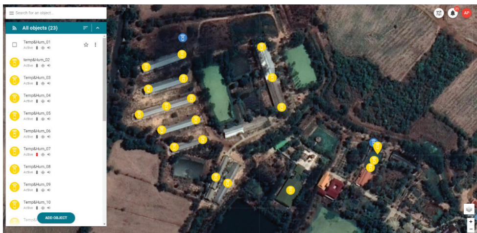
ภาพที่ 15 การติดตั้งจำนวนเซนเซอร์อุณหภูมิและความชื้นทั้ง 20 ชุดในเล้าหมู
