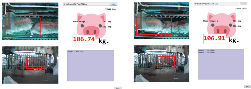
ภาพที่ 16 ตัวอย่างการคำนวณน้ำหนักหมูด้วยภาพ
