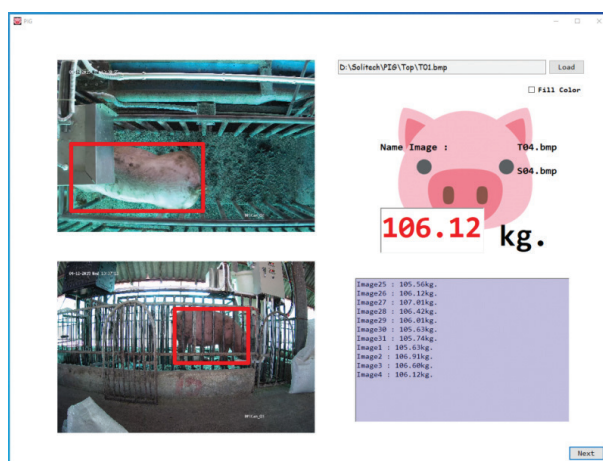
ภาพที่ 9 โปรแกรมตรวจสอบน้ำหนักหมูด้วยภาพ
