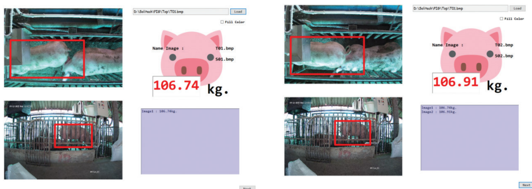
ภาพที่ 11 ตัวอย่างการคำนวณน้ำหนักหมูด้วยภาพ
