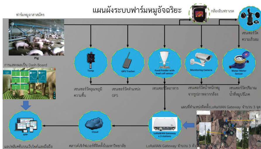
ภาพที่ 1 แนวความคิดในการติดตั้งระบบฟาร์มหมูอัจฉริยะ
