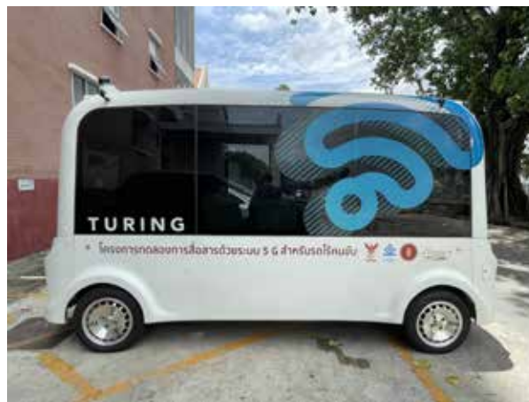
ภาพที่ 1 ยานยนต์ไฟฟ้าที่นำมาพัฒนาเป็นแพลตฟอร์มยานยนต์รับส่งผู้โดยสารอัตโนมัติในโครงการ
