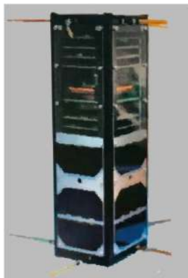
ภาพที่ 5 ดาวเทียม CubeSat ขนาด 3U ทำหน้าที่ติดต่อสื่อสารกับอุปกรณ์ IoT ภาคพื้นดิน เป็นการออกแบบและพัฒนาร่วมกันระหว่างกองทัพอากาศไทยกับ INSTED
