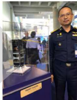
ภาพที่ 5 ดาวเทียม CubeSat ขนาด 3U ทำหน้าที่ติดต่อสื่อสารกับอุปกรณ์ IoT ภาคพื้นดิน เป็นการออกแบบและพัฒนาร่วมกันระหว่างกองทัพอากาศไทยกับ INSTED
