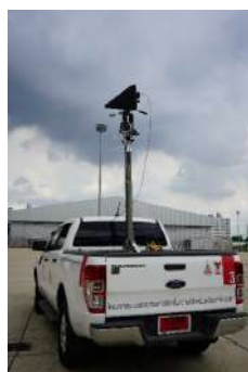
(ก) การติดตั้งสายอากาศบนรถยนต์โมบายล์
