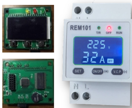
ภาพที่ 7 ต้นแบบเซอร์กิตเบรกเกอร์ที่บรรจุสมองกลและจอแสดงผล
