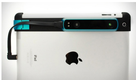
ภาพที่ 9 ผลิตภัณฑ์กล้อง 3 มิติที่สามารถเก็บภาพและสร้างมุมมองแบบ AR – เซนเซอร์จับโครงสร้าง
