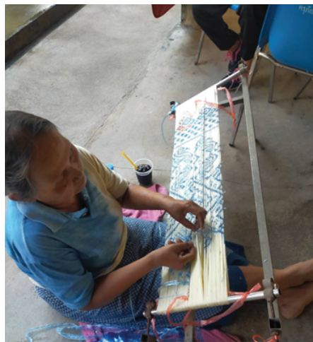
ภาพที่ 2: การสร้างลวดลายผ้าทอด้วยการมัดหมี่โดยช่างมัดหมี่ผู้ที่มีความชำนาญ
