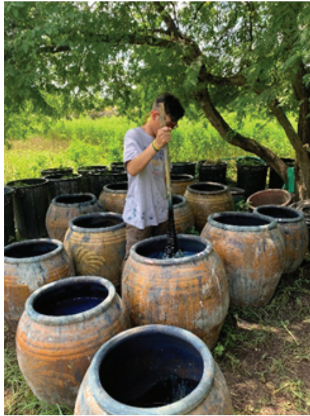
ภาพที่ 1: การผลิตเนื้อครามของชุมชนบนเทือกเขาภูพาน
