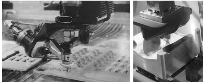
รูปที่ 2 แสดงการสร้างรูปทรงทดสอบด้วยเครื่องขึ้นรูปโลหะแผ่น ที่มา: ผู้วิจัย (2556)
