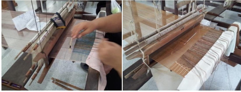
รูปที่ 7 วิธีการทอผ้าแพรวา ทำการจกและมัดลายจากด้านบนแต่ผลลัพธ์ของลายจะปรากฏด้านล่าง
