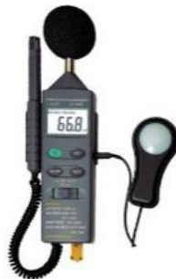
รูปที่ 17 เครื่องวัดสภาพแวดล้อม แสง
