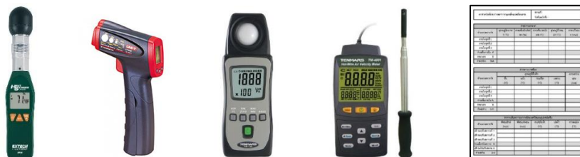
รูปที่ 4 เครื่องวัดดัชนีความร้อน เครื่องวัดอุณหภูมิพื้นผิว เครื่องวัดแสง เครื่องวัดความเร็วลม และแบบฟอร์มบันทึกผล
