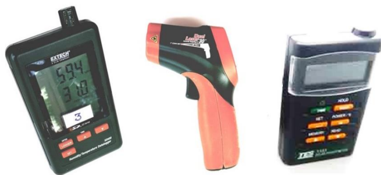
รูปที่ 4 เครื่องบันทึกอุณหภูมิอากาศและปริมาณความชื้นสัมพัทธ์ รุ่น EXTECH SD500 (ซ้าย) เครื่องวัดอุณหภูมิผิวระยะไกล รุ่น EXTECH 42512 Dual Laser (กลาง) และเครื่องวัดปริมาณรังสีดวงอาทิตย์ รุ่น TES-1333 (ขวา) ที่ใช้ในการวิจัย
