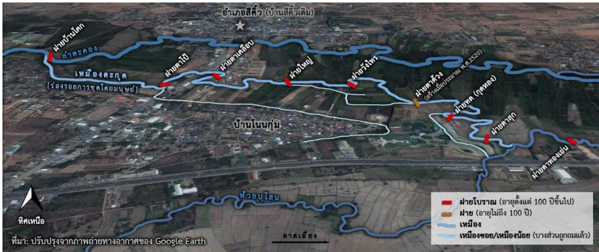
รูปที่ 14 ระบบเหมืองฝายและร่องรอยเครือข่ายชลประทานของบ้านโนนกุ่ม ที่มา: ดัดแปลงจาก Google Earth (2015)
