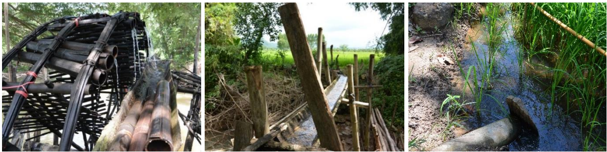
รูปที่ 7 การลำเลียงน้ำจากระหัดผ่านรางน้ำไปสู่ที่นา
