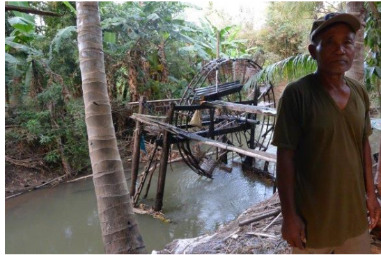
รูปที่ 9 ระเบิดวิดน้ำที่มีกงล้อขนาดใหญ่ในเขตอำเภอปากช่องซึ่งเป็นพื้นที่เชิงเขาที่มีร่องน้ำลึกและตลิ่งสูงชัน (ซ้าย) และระเบิดวิดน้ำที่มีกงล้อขนาดเล็กในเขตอำเภอสูงเนินซึ่งเป็นพื้นที่ราบและตลิ่งไม่สูง (ขวา)
