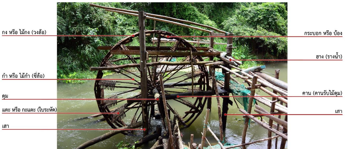
รูปที่ 8 รูปแบบและส่วนประกอบของระหัดวิดน้ำลำตะคอง
