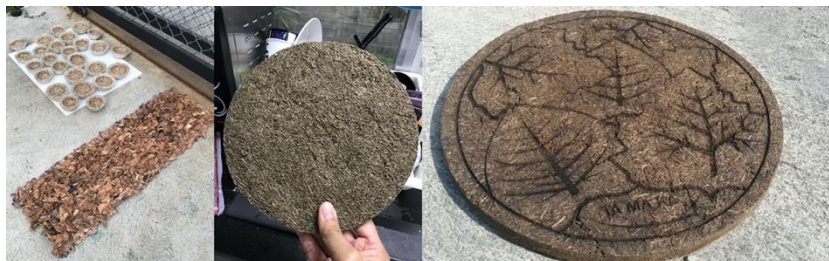
รูปที่ 8 ตัวอย่างการทดลองของเสียที่มีศักยภาพต่ำในการนำกลับไปทำผลิตภัณฑ์ใหม่ ภาพซ้ายและกลางแสดงการเตรียมของเสียให้มีความคงตัว (ปั้นหรือหั่นเป็นชิ้นเล็ก ทำให้แห้งสนิท) จากนั้นผสมกับกากอัดลงแม่พิมพ์เพื่อให้ได้รูปทรง ส่วนภาพทางขวาคือทดลองทำลวดลายกราฟิกด้วยวิธีเลเซอร์ลงบนผิวชิ้นงาน
