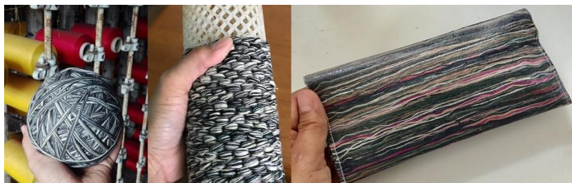
รูปที่ 6 ตัวอย่างการทดลองวัสดุจากเศษเส้นใยจากการทอผ้าขาวม้า (ภาพซ้ายมือ) ซึ่งเป็นของเสียที่มีศักยภาพสูง โดยภาพกลางเป็นการทดลองสานกับวัสดุผ้าตาข่าย ส่วนภาพขวาทดลองคลี่เส้นใยให้แผ่ออกบนผ้ากาว
