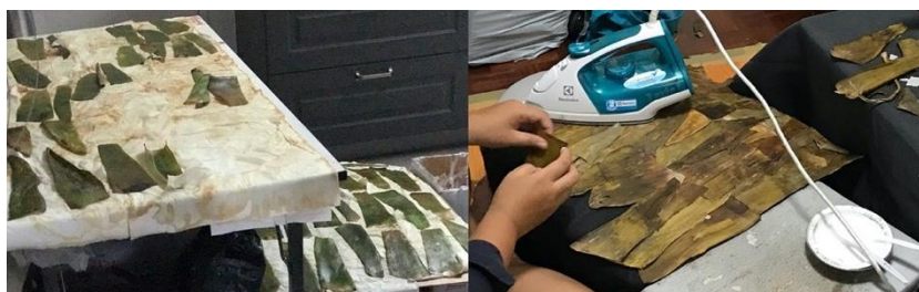
รูปที่ 7 วัสดุเปลือกวุ้นทางจระเข้ที่เป็นของเสียที่มีศักยภาพปานกลางที่มีคุณสมบัติไม่คงตัว จึงต้องมีขั้นตอนในการทำให้วัสดุคงตัว คือ การล้างเอาเมือกออก ตากให้แห้ง และรีดให้แห้งสนิท ก่อนไปทำผลิตภัณฑ์ใหม่
