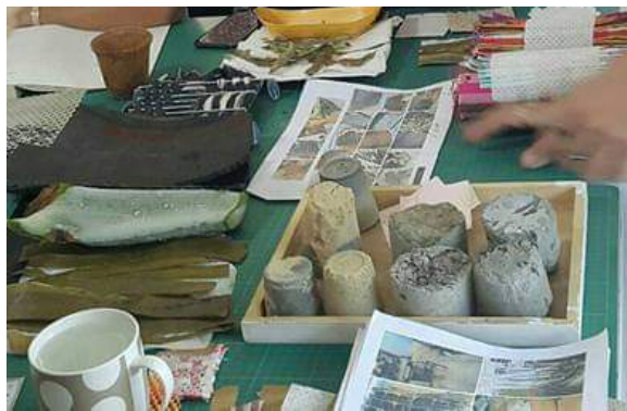
รูปที่ 3 ตัวอย่างการทดลองวัสดุด้วยการให้ความร้อน (ซ้าย) และการหล่อขึ้นรูปแบบใช้ตัวประสาน (ขวา)
