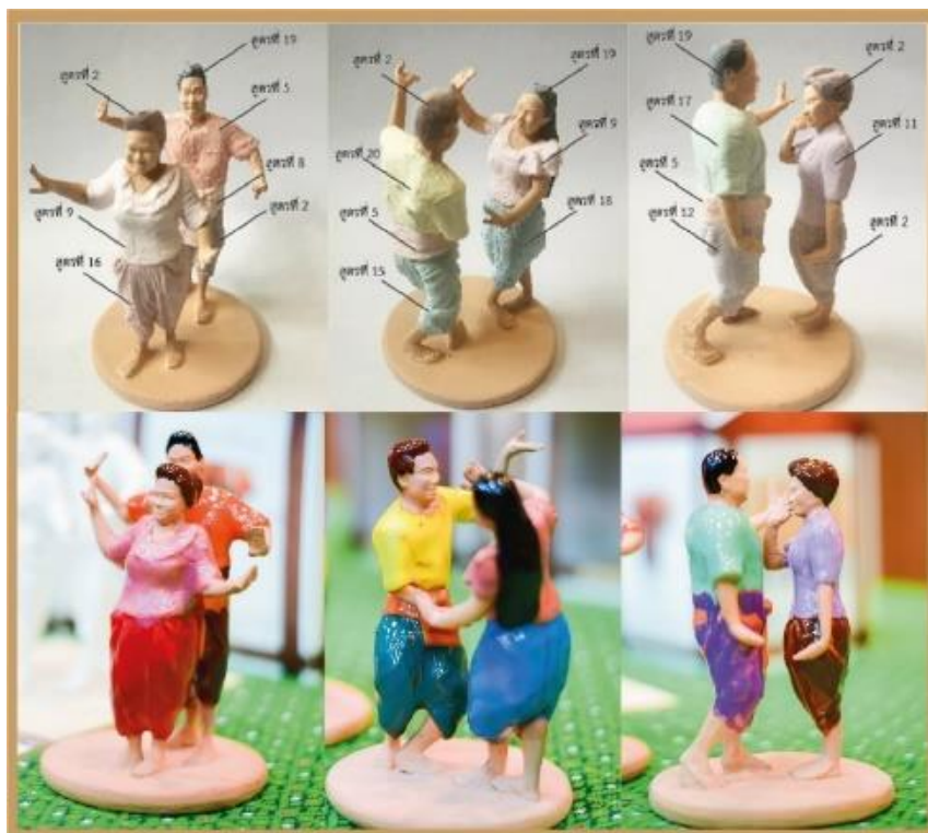
รูปที่ 6 ทาน้ำเคลือบกับชิ้นงานที่เผาในอุณหภูมิ 900°C และเผาตกแต่งเคลือบในอุณหภูมิ 1,100°C
