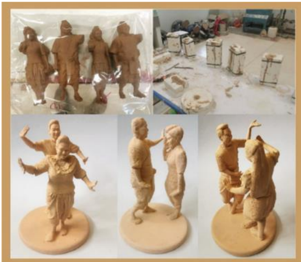
รูปที่ 5 การหล่อน้ำดินจากแม่พิมพ์และการตกแต่งชิ้นงานก่อนเผาในอุณหภูมิ 900 °C
