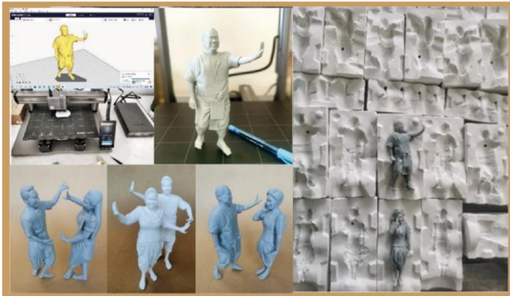
รูปที่ 3 สร้างต้นแบบจาก "การพิมพ์สามมิติ" (3D Printing) และนำมาทำแม่พิมพ์ปูนปลาสเตอร์สำหรับหล่อชิ้นงาน
