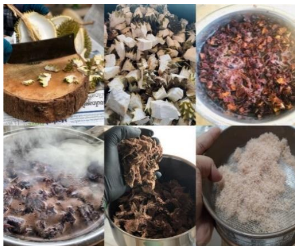
รูปที่ 3 กระบวนการเตรียมเส้นใยจากเปลือกทุเรียน
