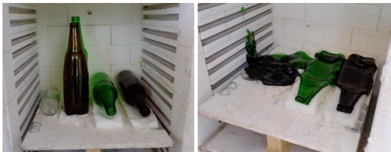
รูปที่ 8 ตัวอย่างผลการทดลองก่อนเผาและหลังเผา การทดลองที่ 1 การทดลองย่อยที่ 4 อุณหภูมิ 800 องศาเซลเซียส
