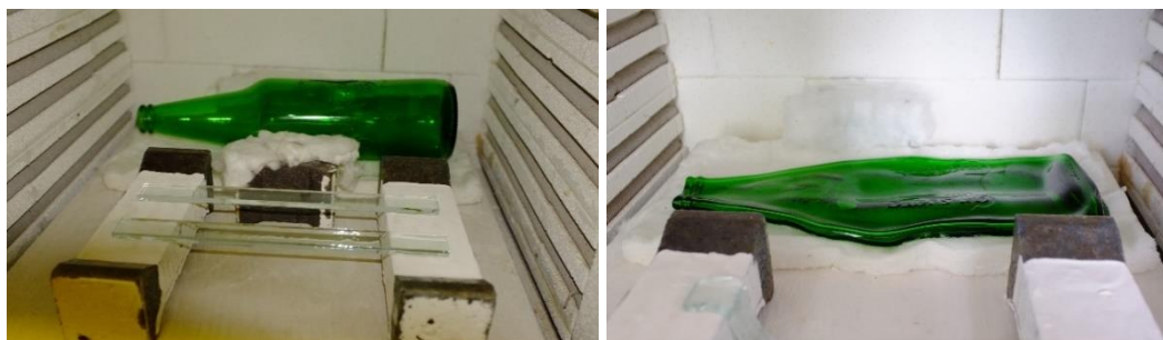
รูปที่ 7 ตัวอย่างผลการทดลองก่อนเผาและหลังเผา การทดลองที่ 1 การทดลองย่อยที่ 3 อุณหภูมิ 750 องศาเซลเซียส
