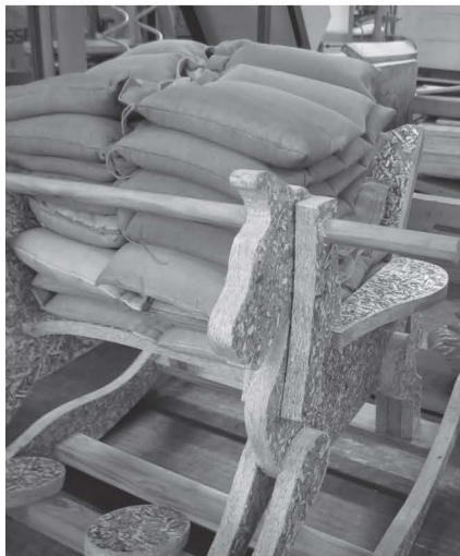
รูปที่ 6 การทดสอบความแข็งแรงของขา ทั้งสองข้าง ปลดปล่อยอิสระกระแทกบนของพื้นนั่งของม้าโยก จำนวน 10 ครั้ง โดยใช้น้ำหนัก 10,000 นิวตัน ถ่วงไว้
