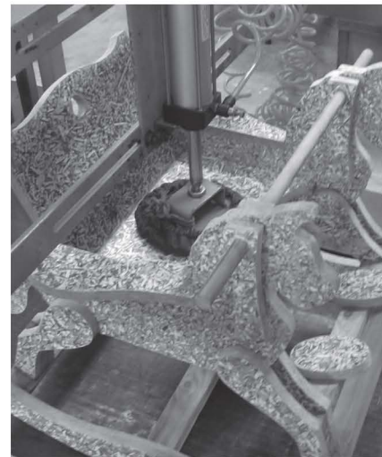
รูปที่ 7 ใช้แรงกระแทกบนพื้นนั่งด้วยตุ้มหนัก 25 กก. สูง 25 ซม. ด้วยแรงกด 390 นิวตัน กระทำบนที่นั่ง จำนวน 10 ครั้ง ที่มา: ภาพการทดสอบทั้งหมดบันทึกภาพโดยผู้วิจัย
