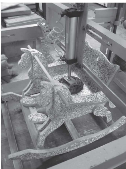
รูปที่ 2 การทดสอบความแข็งแรงของที่นั่ง โดยใช้แรงกดกระทำในแนวดิ่งด้วยน้ำหนัก 13,000 นิวตัน จำนวน 10 ครั้ง
