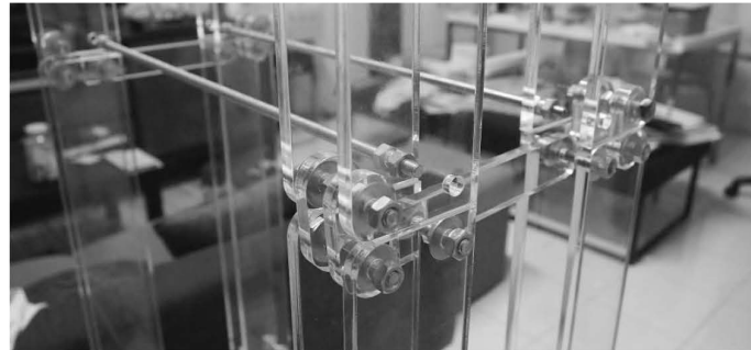
รูปที่ 5.8 ขาอะคริลิกที่ยึดขาหน้าและขาหลังด้วยตัวล็อคตะขอและยึดตามความกว้างด้วยน็อตสตัด ที่มา: ผู้วิจัย (5 พ.ค. 55)
