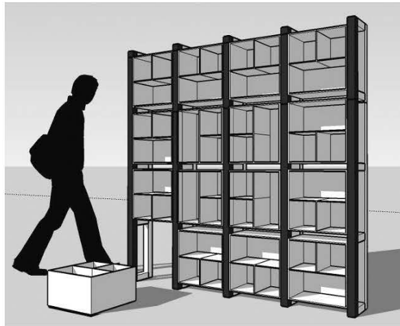
รูปที่ 4.12 ภาพแนวความคิดของตัวชั้นที่สามารถขยายออกด้านข้างและถอดชั้นของที่ละชุดพร้อมของภายในชั้น รูปแบบของโครงสร้างในแบบแรกจะเป็นโครงเหล็กที่มีขนาดตายตัว ที่มา: ผู้วิจัย
