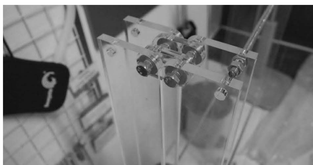
รูปที่ 5.5 การยึดขาบนและขาล่างด้วยข้อพับอะคริลิคด้วยนอตสกรู ที่มา: ผู้วิจัย (5 พ.ค. 55)
