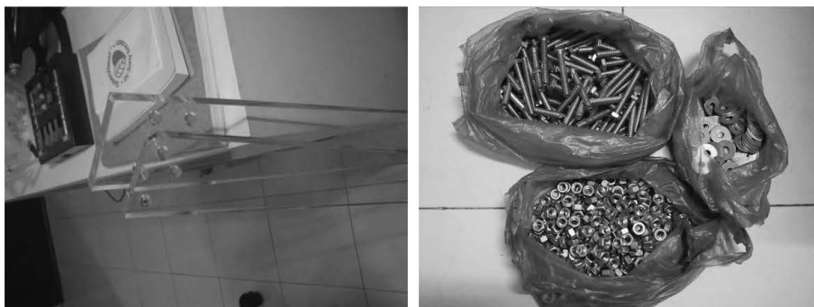
รูปที่ 5.1-5.2 แผ่นอะคริลิกหนา 1 ซม. ที่ตัดเลเซอร์ตามขนาดที่กำหนด และน็อตสกรูขนาด 5/16" x 3" ตัวผู้ ตัวเมีย และแหวนอีแปะ ที่มา: ผู้วิจัย (5 พ.ค. 55)
