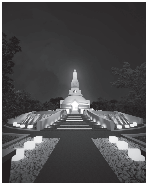
รูปที่ 17 ภาพจำลอง 3 มิติ แสดงการออกแบบระบบไฟฟ้าส่องสว่าง เพื่อเน้นความสำคัญของเจดีย์ในยามค่ำคืน
