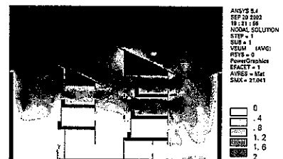
รูปที่ 15 ผลการทดลองด้วยคอมพิวเตอร์ แสดงความเร็วลมภายในอาคาร ตึกแถวแบบทางเลือกที่ 3 กรณีที่ 3
