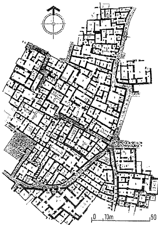
รูปที่ 4 แสดงผังของเมือง Ur อันเป็นตัวแทนแสดงภูมิปัญญาเกี่ยวกับการวางผังอาคารและถนนเพื่อตอบรับกับสภาพภูมิอากาศที่แห้งแล้งในยุคอารยธรรมเมโสโปเตเมีย [ที่มา (2) หน้า 23]
