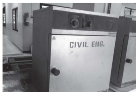
รูปที่ 1 เตรียมวัสดุสำหรับทำแผ่นตัวอย่างและทำการอบด้วยตู้อบเพื่อลดความชื้นในเนื้อของวัสดุก่อนทำการขึ้นแผ่น
