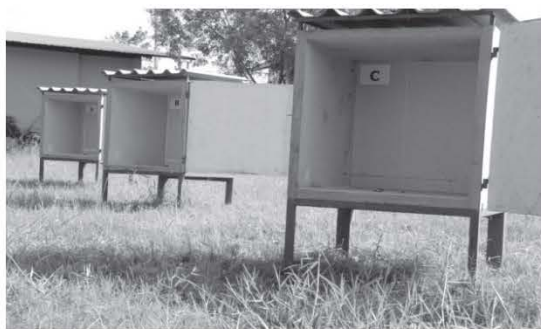
รูปที่ 2 กล่องทดลองจำนวน 3 กล่อง สำหรับทดลองการดูดความชื้นของแผ่นตัวอย่าง
