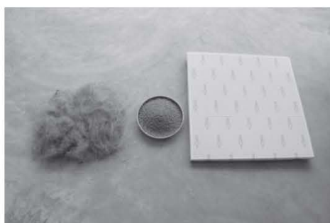
รูปที่ 1 เตรียมวัสดุสำหรับทำแผ่นตัวอย่างและทำการอบด้วยตู้อบเพื่อลดความชื้นในเนื้อของวัสดุก่อนทำการขึ้นแผ่น
