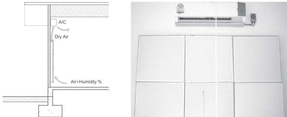
รูปที่ 8 ติดตั้งแผ่นบริเวณใต้เครื่องปรับอากาศ พื้นที่ของแผ่นผนัง 3.24 ตารางเมตรต่อพื้นผิวผนังอาคาร 48 ตารางเมตร
