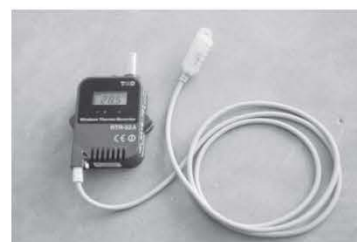
รูปที่ 3 แสดงการติดตั้งเครื่อง Hobo RTR-50 เพื่อตรวจวัดค่าความชื้นภายใน และภายนอกกล่องทดลอง
